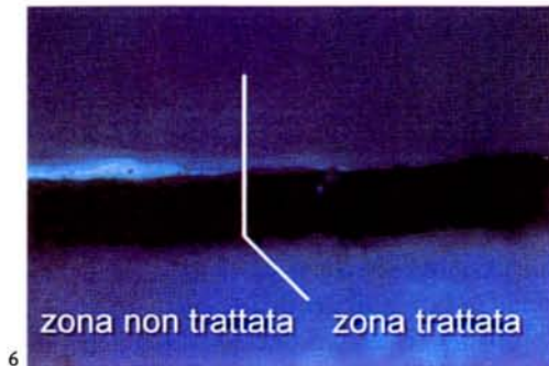
Fig. 6- Sezione stratigrafica di un campione di pittura a ocra gialla a uovo con finitura di vernice dammar: a sinistra la zona non trattata, a destra la superficie dopo l'impulso laser (12 m).
